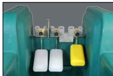
Вариант Е: 2 клапана MAXIFLOW (до 80 л/мин!) 1 клапан низкого давления
