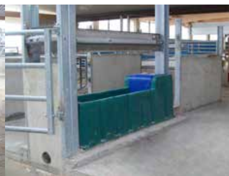
Вариант И: 1 клапан MAXIFLOW (тупиковый водопровод, труба обмотана термошнуром 24 В, 20 Вт, 2 м), 1х нагревательный тэн 24 В, 180 Вт
